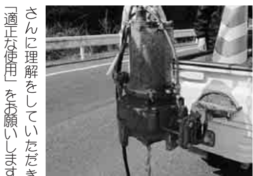
▲異物が詰まり故障したポンプ
