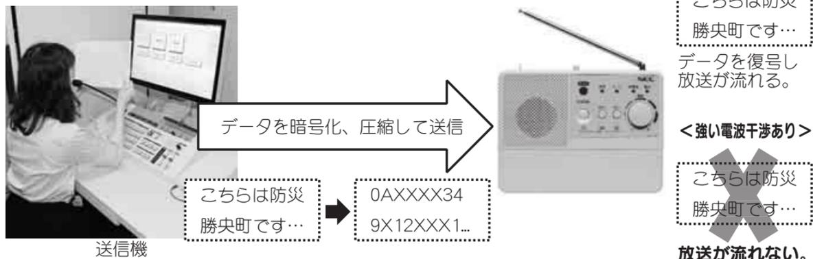
放送途中で途切れるなど、正しく受信できていない場合は、電波干渉を受けている可能性があります。このような場合はダイポールアンテナ（屋外にアンテナを設置し、ケーブルを接続する）の設置を行っています。
